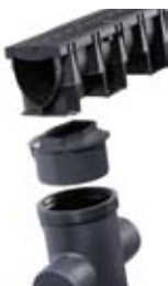
Žlabová vpust s košem na hrubé nečistoty, s možností vytvoření pachového uzávěru - sifonu a připojovacím adaptérem.
