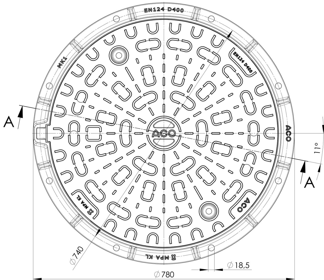
Einlaufquerschnitt / inlet area: 520 cm<sup>2</sup>
