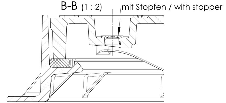
mit Schmutzfängeraufnahme / with gully trap holder
