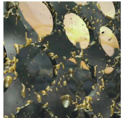
Malé kapky oleje, které nelze oddělit na základě rozdílné hustoty s vodou, drží na koalescenčním prvku.
