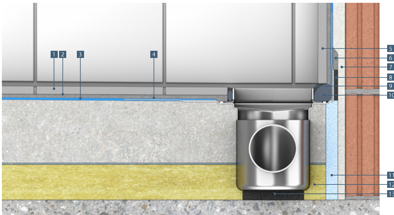
Příčný řez, návrh instalace ACO ShowerDrain E+ (skladba podlahy podle testovacího předpisu zvukové izolace)
