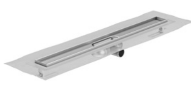
ACO ShowerDrain C průtok 0,91 l/s (dle ČSN EN 1253-1)
