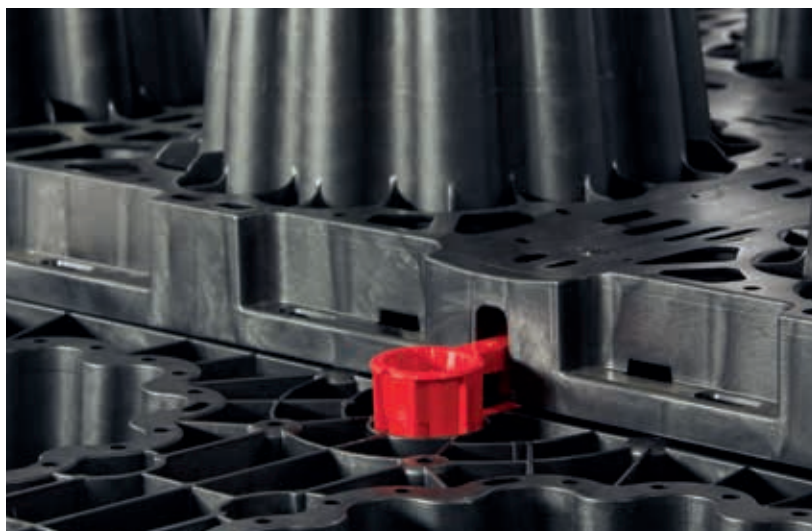
ACO Stormbrixx HD: Zwei zusammengesteckte Verbinder sichern die Ausrichtung der Pylonen zweier Einbaulagen
