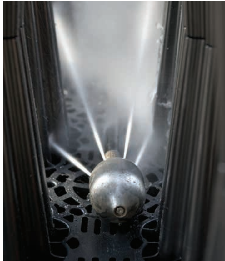
Reinigungsgerät mit Spülkopf. Die Druckspülung und das Absaugen eventueller Absetzungen sind zeitgleich möglich.
