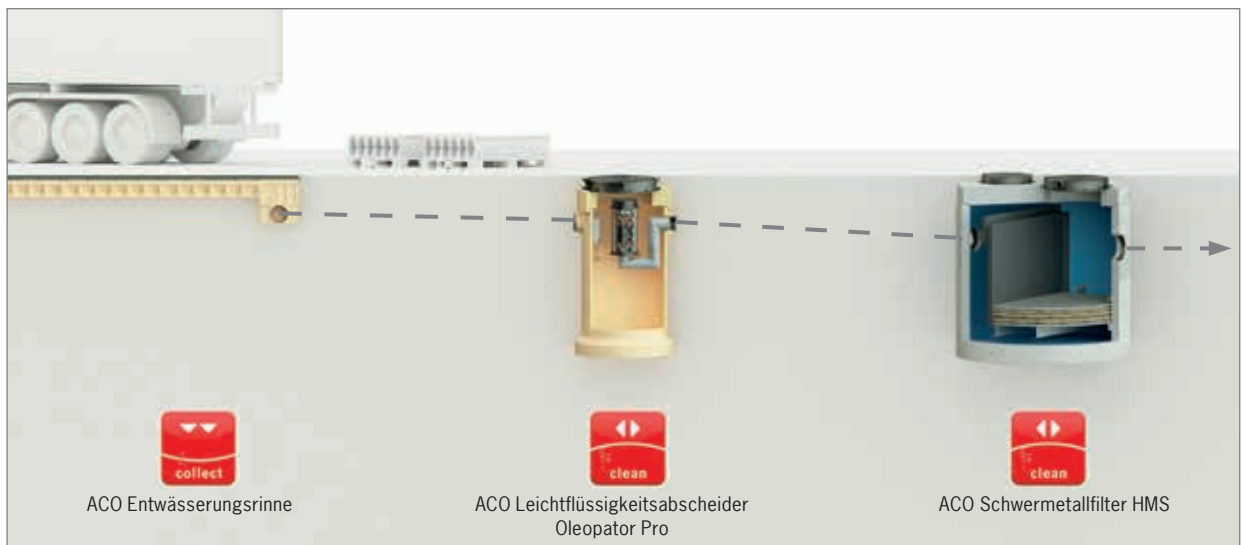
Anwendungsbeispiel ACO Systemkette für eine Regenwasservorreinigung
