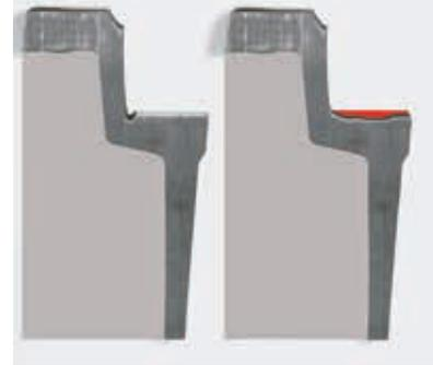
Links ein Schnitt durch einen neuen Rahmen, rechts ein Schnitt durch einen Rahmen gleichen Typs nach einer Einsatzdauer von einigen Jahren.
