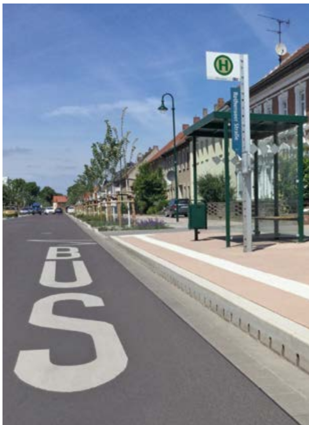
Bezbariérový nástup do autobusu díky obrubě vysoké 18 cm
