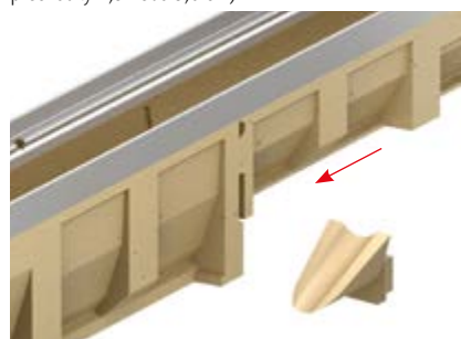
Kaskádové napojení v případě žlabů s různou stavební výškou za pomoci přechodky 2,5 nebo 5,0 cm)
