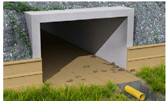
Climate Plate jako vhodný povrch pro pohyb obojživelníků v propustku
